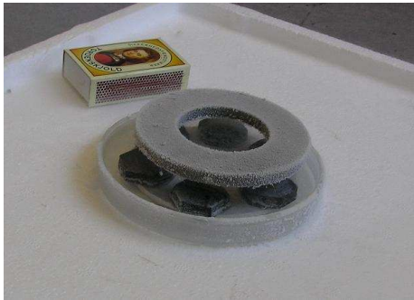
Figur 1: Ringformet magnet, der svæver ca. 1 cm over en superleder nedkølet til -192^{\circ}\text{C} med flydende nitrogen.
